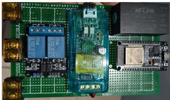
Gambar 3. Implementasi perangkat sistem monitoring energi listrik
