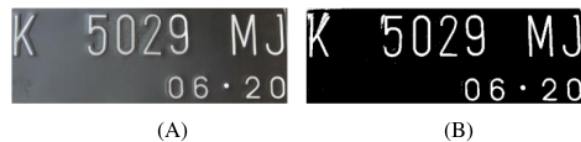
Gambar 8. Binerisasi citra, (A) Data input berupa citra RGB (B) citra setelah binerisasi
