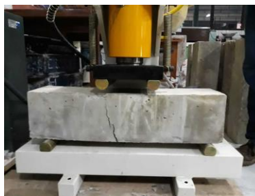
Gambar 4. Uji Lentur Balok Sumber : Dokumentasi Peneliti, 2021
