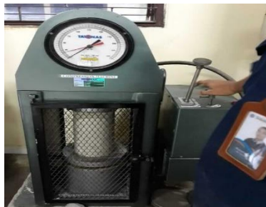
Gambar 3. Uji Silinder Beton Sumber : Dokumentasi Peneliti, 2021
