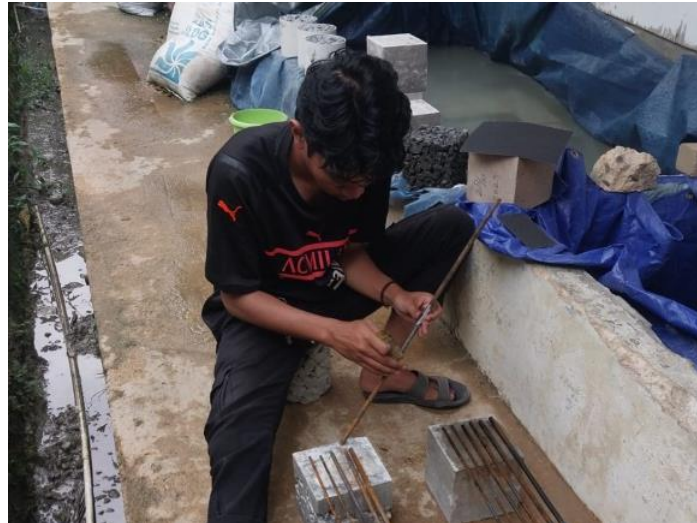
Gambar 5. Proses pembersihan tulangan setelah proses korosi berakhir.
