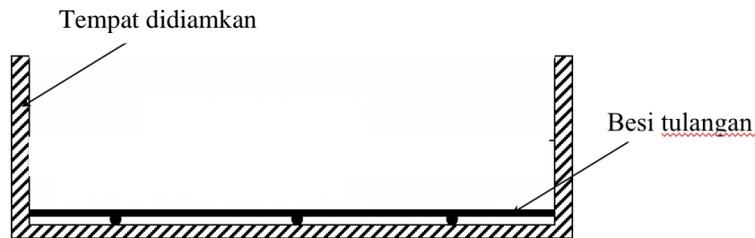
Gambar 4. Proses pengkorosian tulangan dengan media ruang terbuka dan ruang tertutup.
