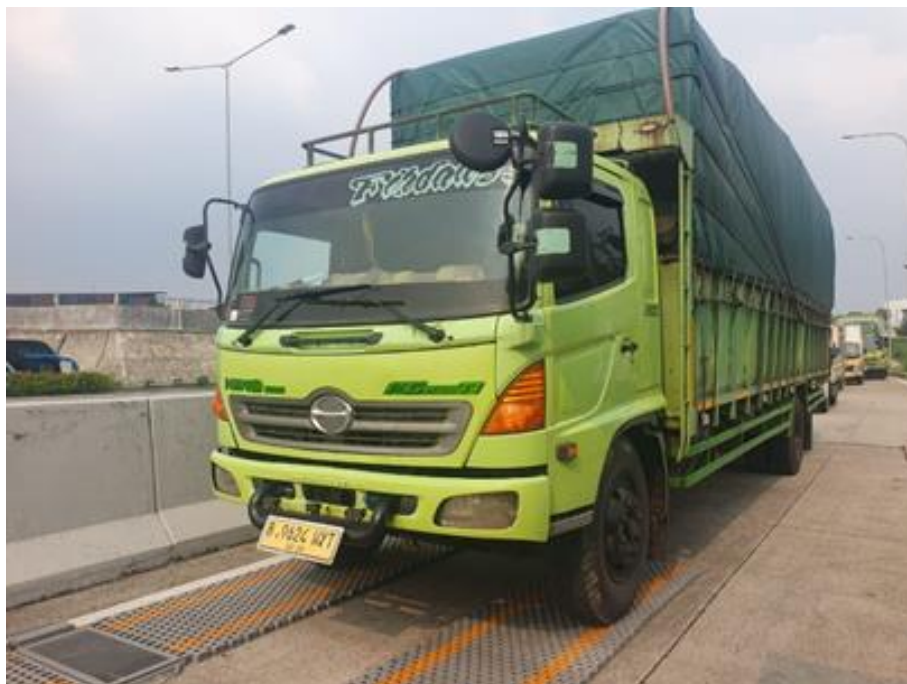
Gambar 2. Kendaraan ODOL Truk Besar, konfigurasi sumbu 1.2
