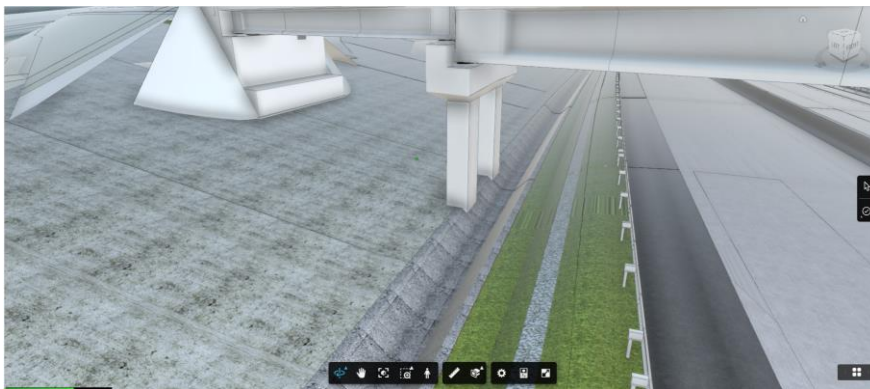
Gambar 2. Implementasi Deteksi Konflik antar Model ( Clash Detection ) di Proyek Studi Sumber: Pemodelan BIM Serpan 2023
