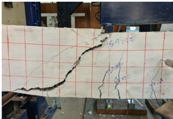
Gambar 11. Keruntuhan Geser pada Balok Sambungan Coupler
