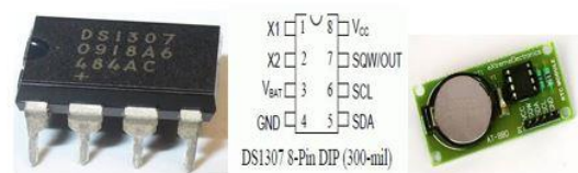
Gambar 3. IC DS1307, bentuk fisik, skematik pin
