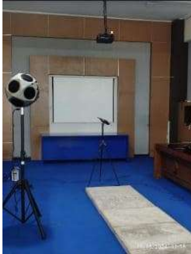
Gambar 3. Skema Pengujian Koefisien Serapan Bunyi dengan Menggunakan metode Reverberation Time
