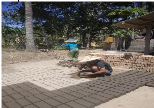
Gambar 5, Observasi pekerjaan orang tua yang sedang membuat batu bata
