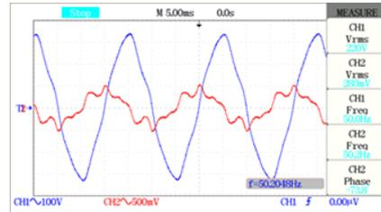
Gambar. 10. Generator Sinkron Dengan Dengan Perbaikan Nilai Beban Kapasitor 60uF
