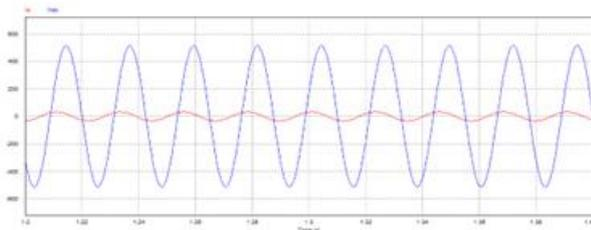
Gambar. 21. Simulasi Generator Sinkron Dengan Beban Resistif Resistif 96,8 Ω Kapasitif 90 uF
