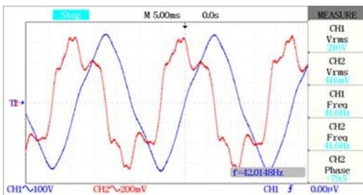
Gambar. 22. Generator Sinkron Dengan Nilai Beban Resistif 96,8 Ω Kapasitif 90 uF
