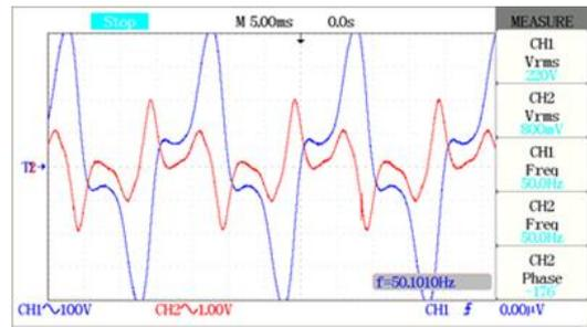
Gambar. 23. Generator Sinkron Dengan Perbaikan Nilai Beban Resistif 96,8 Ω Kapasitif 90 uF
