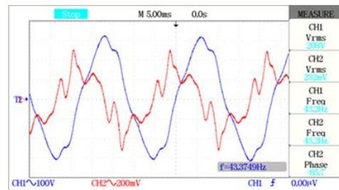
Gambar. 18. Generator Sinkron Dengan Beban Resistif 96,8 Ω Kapasitif 60 uF
