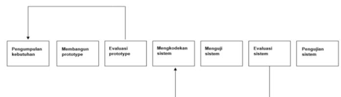
Gambar 3. Alur Pemodelan Prototype Perangkat Lunak
