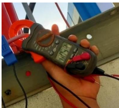
Gambar 15. Pengujian Pembacaan Nilsi Arus
