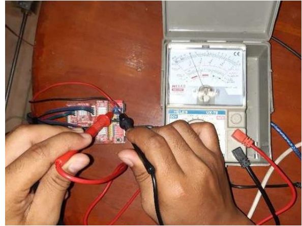
Gambar 29. Pengukuran Power Supply
