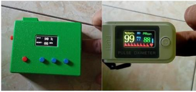
Gambar 3. Pengukuran SPO 2 , BPM dengan Diagnostic Pocket dan Pulse Oximeter
