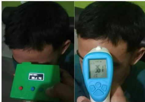
Gambar 4. Pengukuran Suhu dengan Diagnostic Pocket dan Thermogun
