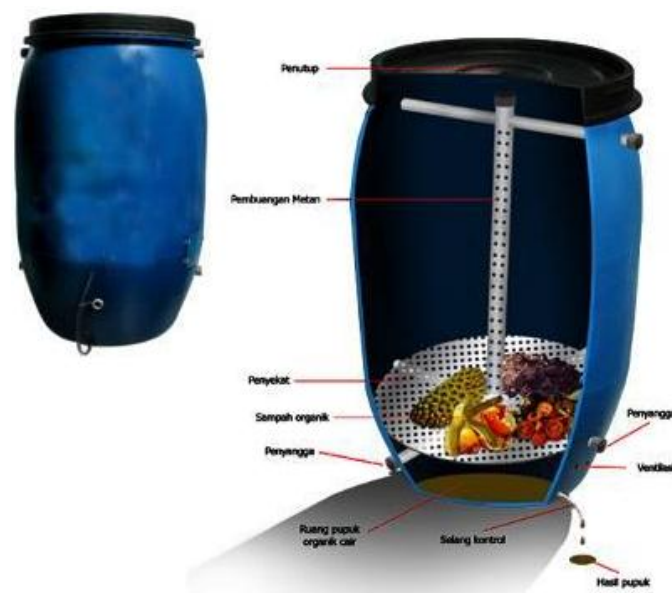
Gambar 2. Recycle Drum untuk Pembuatan Pupuk Organik
